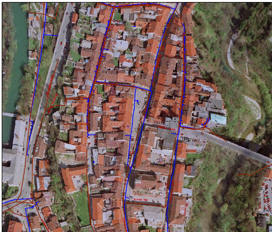
Slika 6: Prikaz vodovodnega in kanalizacijskega omrežja na obravnavanem območju. Vir: Komunala Kranj ( URL: http://gis.komunala-kranj.si/KomunalaKranj/frames.asp )
