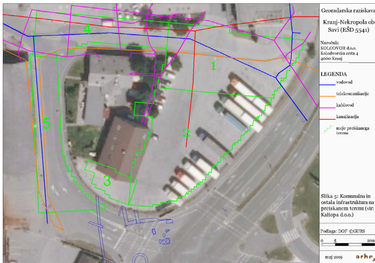
Slika 5: Položaj evidentiranih komunalnih vodov ( https://gis.iobcina.si/gisapp/Default.aspx?a=Kranj ) glede na preiskane sektorje.
