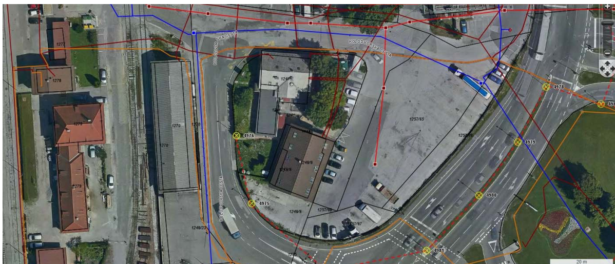
Slika 4: Posnetek zaslona z aplikacije podjetja Kalipoa d.o.o. ( https://gis.iobcina.si/gisapp/Default.aspx?a=Kranj ) z vrisanimi komunalnimi vodi na preiskanem terenu.
