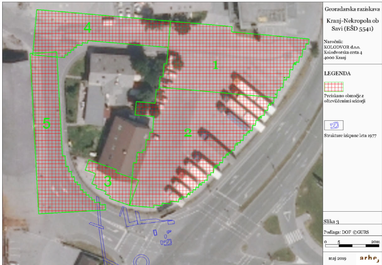
Slika 3: Raziskan teren z vrisanimi sektorji na podlagi digitalnega ortofoto posnetka GURS-a. Opazen je zamik podlage (posnetka) glede na dejansko geodetsko umestitev. Geodetsko umestitev meritev je izvajal Boštjan Trobiš iz podjetja GEONEP d.o.o. Geodetsko umeščanje struktur ugotovljenih pri arheoloških izkopavanjih leta 1977 je izdelal Robert Erjavec.
