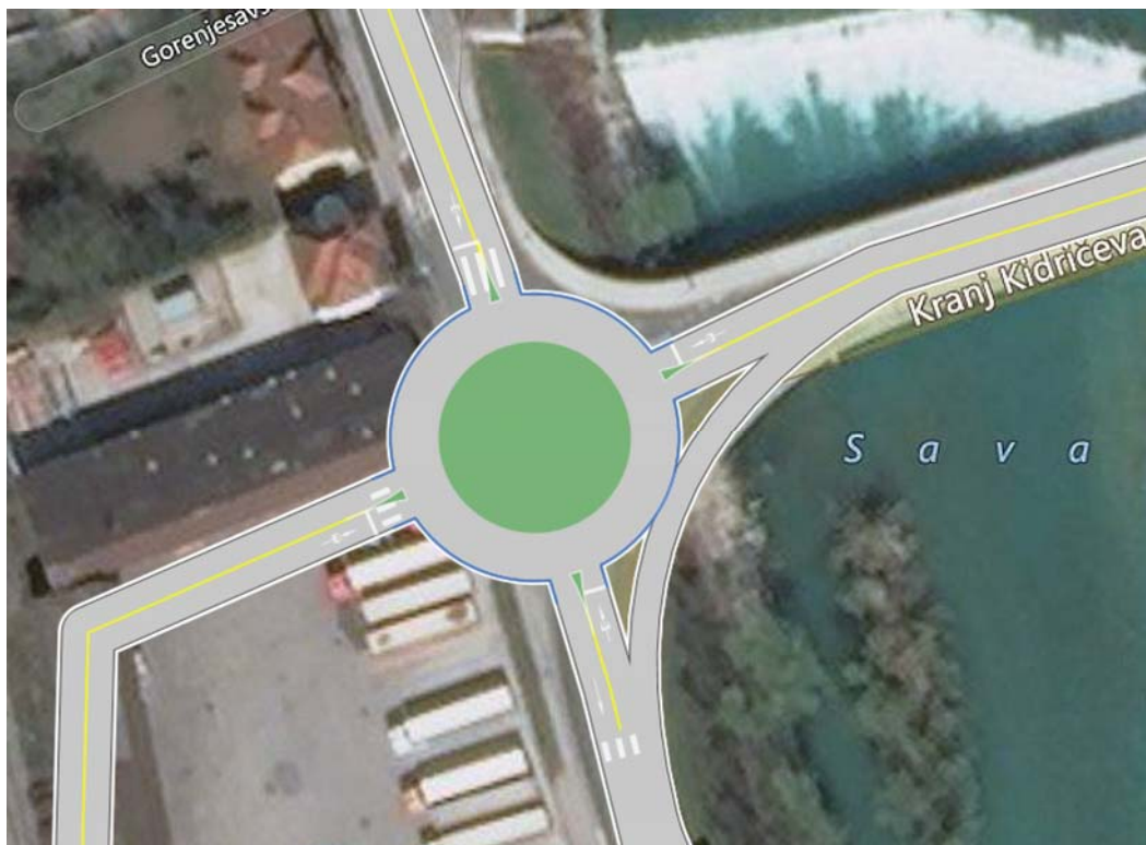
Slika 11: Predlog uvedbe mimobežnega pasu v krožnem križišču K3
