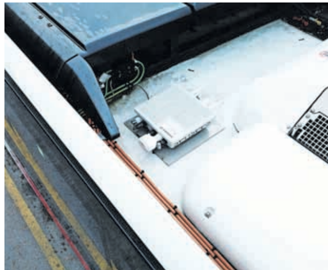
Senzor za merjenje kakovosti zraka, nameščen na streho avtobusa / Foto: MOK
