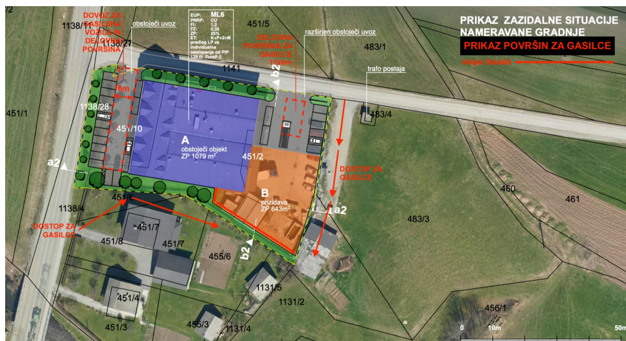
Slika 8a: Prikaz intervencijskih in delovnih površin za gasilce
