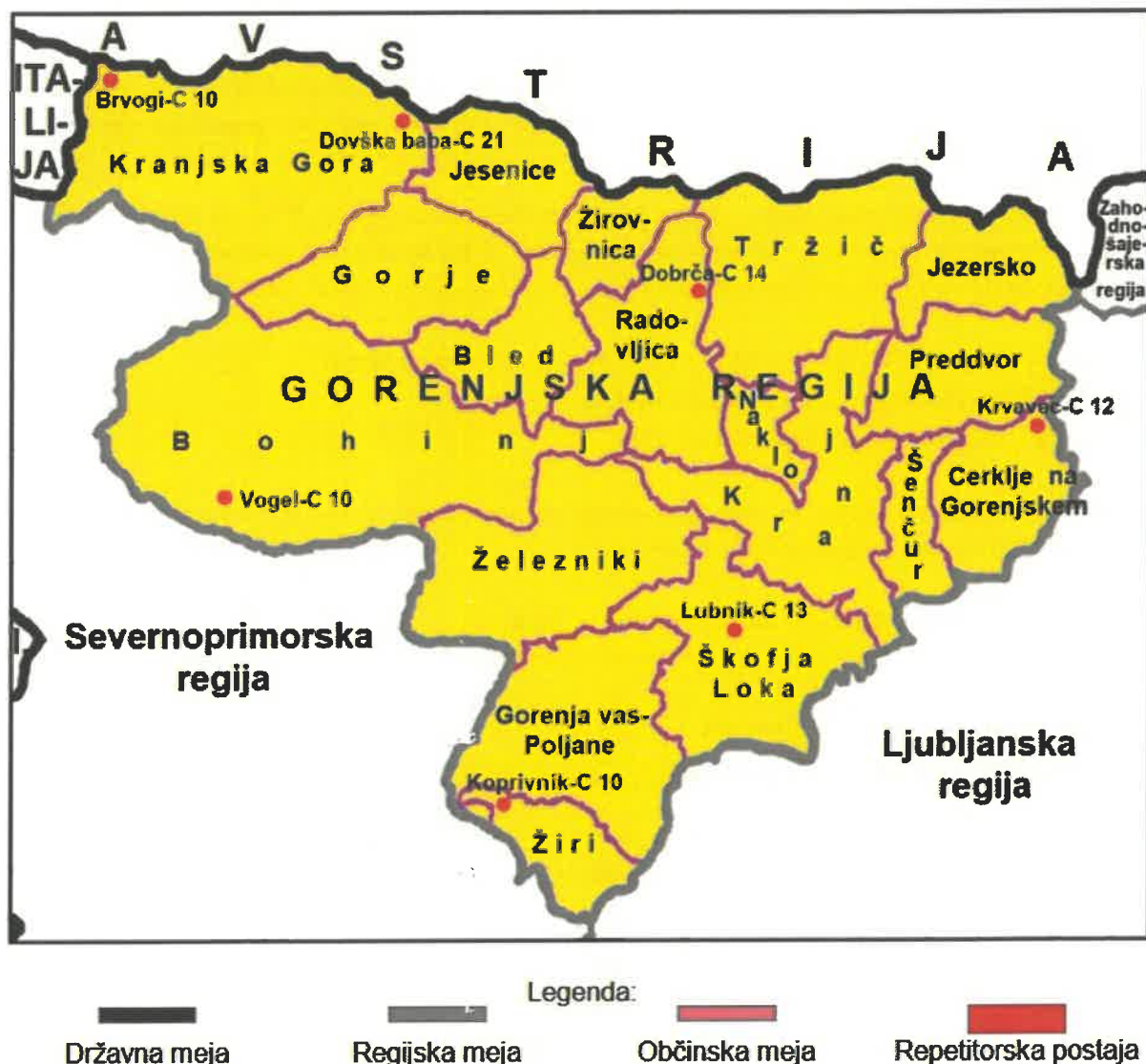
Slika 2: Repetitorske postaje s kanali sistema ZA-RE
